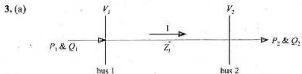
ऊपर चित्र में,  $V_1 = 1\angle 0^\circ$ ,  $Z_l = (0.05 + j 0.02) \text{ pu}$  और  $P_2 + jQ_2 = (1.0 + j 0.6) \text{ pu}$  है। भार प्रवाह अध्ययन का उपयोग करते हुए पारस्परिक तौर पर  $V_2$  और  $P_1 + jQ_1$  की गणना कीजिए।
